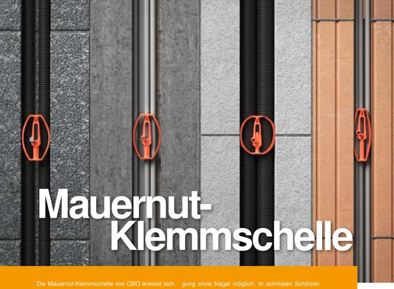
Die Mauernut-Klemmschelle von OBO erweist sich auf jeder Baustelle als cleverer Problemlöser: Sie deckt nicht nur vielfältige Schlitzbreiten ab (von <27mm bis >45mm) und kann auf diversen Untergründen wie Beton oder Kalk-Sandstein befestigt werden, sondern überzeugt auch mit einem integrierten Bastsystem. Durch dieses ist eine Befesti-
