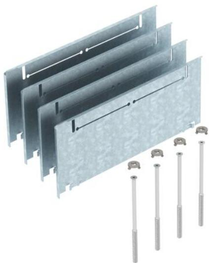
Höhenausgleich-Bausatz für Unterflurdosen UZD250-3 mit einer Bauhöhe von 165 bis 220 mm für die bauseitige Erhöhung der UZD auf eine Höhe von 215-270 mm, bestehend aus 4 Fallblechen, 4 Nivellierschrauben und 4 Drehverschlüssen.
