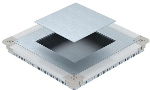
Unterflur-Gerätedose mit Montagedeckel und Deckelblindplatte mit Seitenwänden aus Stahlblech. Für den Einbau eines quadratischen Geräteeinsatzes GES9 55 in Estrichhöhen ab 55 mm. Lässt sich stufenlos auf Estrichnennhöhe nivellieren und der Estrich kann bündig an die Estrichabzugskante angearbeitet werden. Mit Rohreinführungsöffnungen je Seite 7 x M20, 3 x M25, 4 x M32. Nutzbarer Rohrgröße bei einer Systemhöhe von 55 mm: M20.
