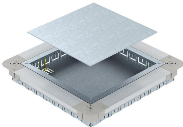
Unterflur-Gerätedose mit Montagedeckel und Deckelblindplatte mit Seitenwänden aus Stahlblech. Für den Einbau eines quadratischen Geräteinsatzes GES9 55 in Estrichhöhen ab 55 mm. Lässt sich stufenlos auf Estrichnennhöhe nivellieren und der Estrich kann bündig an die Estrichabzugskante angearbeitet werden. Mit Rohreinführungsöffnungen je Seite 7 x M20, 3 x M25, 4 x M32. Nutzbare Rohrgröße bei einer Systemhöhe von 55 mm: M20.
