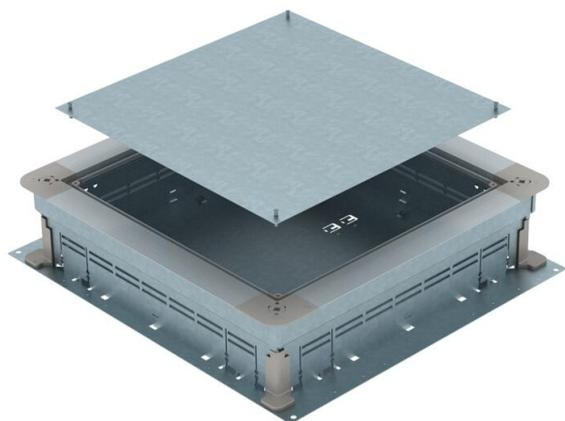
Unterflur Zug- und Abzweigdose für estrichüberdeckte Unterflur-Installationskanäle mit Seitenwänden aus Stahlblech. Zur Montage von Einbaueinheiten in Montagegedeckel (separat zu bestellen). Lässt sich stufenlos auf Estrichnennhöhe nivellieren (Schnellnivellierung möglich) und der Estrich kann bündig an die Estrichabzugskante angearbeitet werden. Mit schalltechnischer Entkopplungsmöglichkeit nach Estrichverlegung und mit Systemzubehör auch für Schwerlastanwendung verwendbar.
