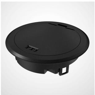
Geräteeinsatz mit Klappdeckel und Rastschieber für Bodensteckdose GES R2 zum direkten Einbau in die Installationsdose MT R2 im Innenbereich. Im geschlossenen Zustand kann die Bodensteckdose nass gepflegt werden.
