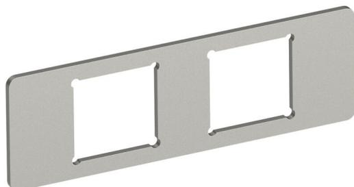
Montageplatte zur Aufnahme von zwei Anschlussbuchsen der Datentechnik folgender Typen: AMP TYCO: Standard 110Connect, SL Serie 110Connect u. Toolless, AMP-Twist ; Brand-Rex: ungeschirmtes Modul; GG45; TKM RJ MOD; Nexans: LANmark Modul mit Adapter-Clip; Siemon CAT6; 3M K6 und K10. Abmessung einer Montageöffnung in mm: 20,10 x 14,80.
