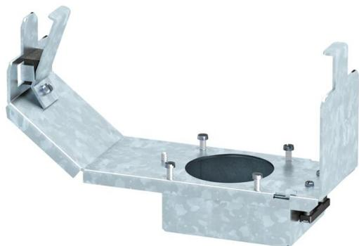
Geräteträger der Nenngröße 3 für den Einbau einer CEE-Steckverbindung 16 A oder 32 A zum Einbau in Geräteinsätzen und Kassetten der Nenngröße R7, 9 und R9. Geräteträger mit Schutzgehäuse und Zugentlastung. Benötigte Mindesteinbautiefe: 190 mm bei Verwendung eines Geradeaus-Steckers und 160 mm bei Verwendung eines Winkelsteckers.
