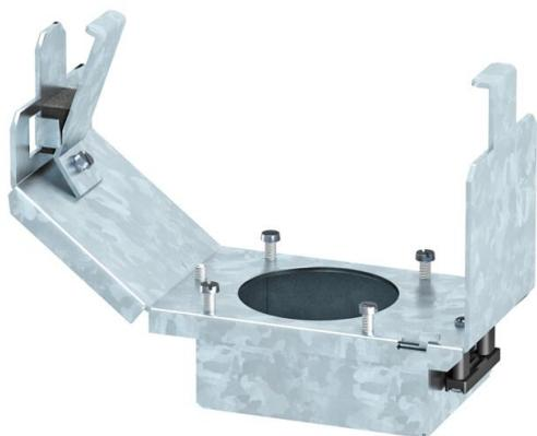
Geräteträger der Nenngröße 2 für den Einbau einer CEE-Steckverbindung 16 A oder 32 A zum Einbau in Geräteinsätzen und Kassetten der Nenngröße 2, 4, 6 und R7. Geräteträger mit Schutzgehäuse und Zugentlastung. Benötigte Mindesteinbautiefe: 190 mm bei Verwendung eines Geradeaus-Steckers und 160 mm bei Verwendung eines Winkelsteckers.
