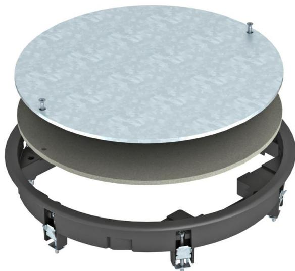
Zugdoseneinsatz zum Blindverschluss einer runden Montageöffnung der Nenngröße R7 in Kanalsystemen sowie in Doppel- und Hohlböden im Innenbereich. Mit Universalbefestigungswinkel. Teppichschutzrahmen aus Polyamid.
