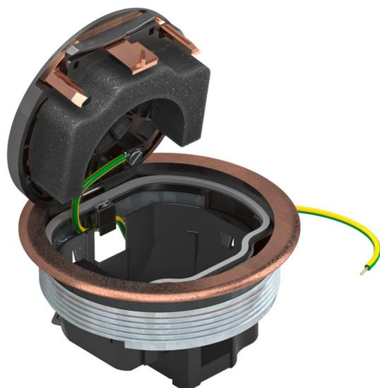
Runde Einbaueinheit mit Bodenbelagschutzrahmen zum direkten Einbau in die Anschlussdose UDL2-120 im Innenbereich. Im geschlossenen Zustand kann die Einbaueinheit nass gepflegt werden. Die Mindesteinbautiefe beträgt 70 mm. Abdeckplatte und Steckdose der Serie Modul45 sind separat zu bestellen.
