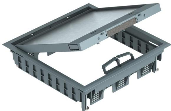
Geräteinsatz mit Rastschieber für bis zu 12 Modul 45-Einzelgeräte in 3 Universalträgern UT4, Einsatz in Kanalsystemen und Systemböden im Innenbereich. Bodenbelagaussparung im Klappdeckel voreingestellt auf 5 mm, bei Bedarf auch einstellbar auf 10 mm.
