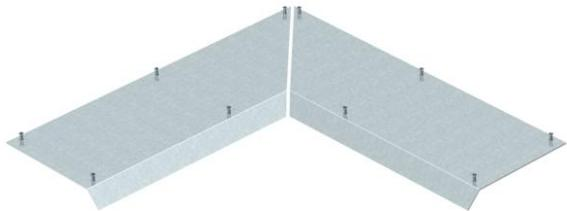
Blinddeckel 2-teilig zum Abdecken des Innenecks eines Auffurkanals, passend zu den Kanalunterteilen AIK/U inkl. 10 Befestigungsschrauben. Der Kanaldeckel wird in den Al-Seitenprofilen des Kanalunterteils festgeschraubt. Die Deckelschräge überragt das Kanalunterteil im 45°-Winkel.
