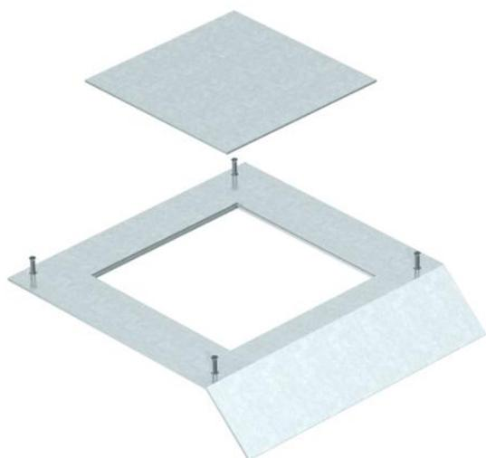
Geräteinsatzdeckel für Kanalunterteil AIK/U für den Einbau eines Geräteeinsatzes der Nenngröße 9. Montageöffnung durch 2-mm-Alu-Blindplatte verschlossen. Der Kanaldeckel wird in den Al-Seitenprofilen des Kanalunterteils festgeschraubt. Die Deckelschräge überragt das Kanalunterteil im 45°-Winkel.
