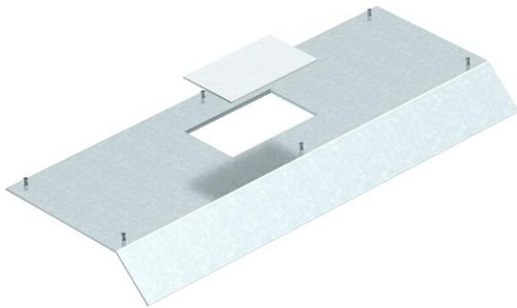
Geräteinsatzdeckel für Kanalunterteil AIK/U für den Einbau eines Geräteinsatzes der Nenngröße 2. Montageöffnung durch 2-mm-Alu-Blindplatte verschlossen. Der Kanaldeckel wird in den Al-Seitenprofilen des Kanalunterteils festgeschraubt. Die Deckelschräge überragt das Kanalunterteil im 45°-Winkel.
