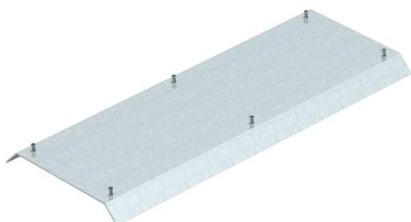
Aufflur-Blinddeckel zum Abdecken des Aufflur-Abzweigkanals AIK/A, passend zu den Kanalunterteilen AIK/U. Der Kanaldeckel wird in den AI-Seitenprofilen des Kanalunterteils festgeschraubt. Die Deckelschräge überragt das Kanalunterteil im 45°-Winkel.
