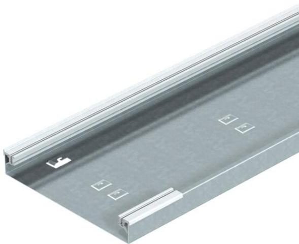
Aufflur-Installationskanal-Unterteil, 1zünftig, für Blind-/Montagedeckel mit einseitiger Abschrägung, mit aufsteckbaren Aluminium-Seitenprofilen zum Auflagern und Befestigen der Kanaldeckel, Bodenwanne mit Haltetaschen für max. 2 einsteckbare, selbstkontaktierende Trennstege und Prägung für Schutzleiteranschlusswinkel. Kanalhöhe geeignet zum Aufbau von Teiltanks.
