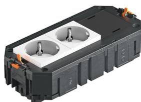
Der anschlussfertige Universalträger UTC3 verfügt über zwei vorinstallierte 33° Schutzkontakt-Steckdose und eine Blindabdeckung für den nachträglichen Einbau von einem Installationsgerät der Serie Modul 45 oder Modul 45connect. Passend zu den Verbindungsleitungen VL und den Geräteeinbaueinheiten der Nenngröße 2, 4, R4, 6 und R7.
