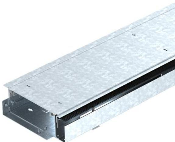
Montagefertige Kanaleinheit zur Leitungsführung und zum Geräteeinbau, bestehend aus einem Kanalunterteil mit zwei Deckeln und einer höhenverstellbaren Bürstenleiste. Im Lieferumfang enthalten sind zwei Deckelstoßdichtungen und ein Verbinder. Zur Höheneinstellung werden sechs Nivelliereinheiten benötigt. Bis maximal 5 kN belastbar. Die Kanaleinheit kann mit ein verstellbaren Bodenbelagsanlegeprofil zur Estrichabgrenzung in Bereichen von Türleibungen und vor Heizkörpernischen ergänzt werden.
