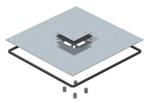
Montagedeckel für Unterflur-Zug- und -Abzweigdosen vom Typ UZD350-3/4 zum Aufbau eines Telitanks. Einbauöffnung 3 mm vertieft zum nachträglichen Blindverschluss mit Deckelblindplatte.
