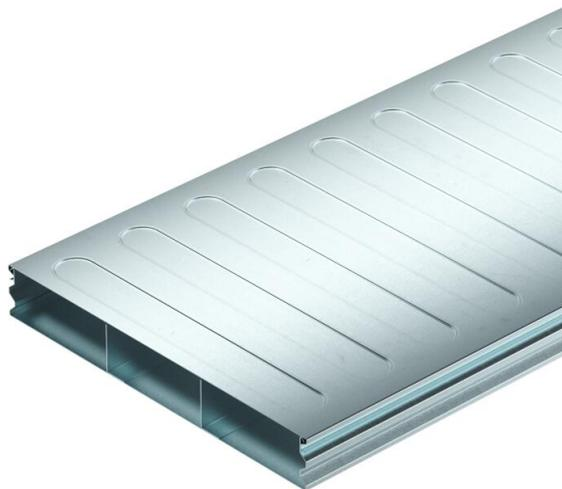
Unterflurkanal (2-teilig) zur Verlegung von Kabeln und Leitungen in estrichüberdeckten Unterflur-Systemen nach EN 50085-2-2. Abnehmbarer und durchgängig aufrastbarer Kanaldeckel. Mit Trennsteg im Kanalunterteil. Die profilierten Seitenwände bieten eine Rastfunktion, um den Kanaldeckel auf das Kanalunterteil zu rasten. Die Versteifungssicken im Kanaldeckel dienen zur Stabilisierung.
