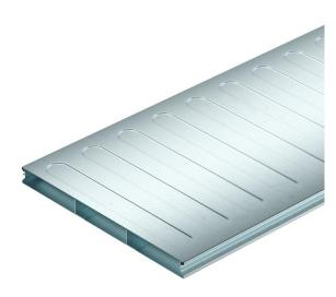
Unterflurkanal (2-teilig) zur Verlegung von Kabeln und Leitungen in estrichüberdeckten Unterflur-Systemen nach EN 50085-2-2. Abnehmbarer und durchgängig aufrastbarer Kanaldeckel. Mit Trennsteg im Kanalunterteil.
