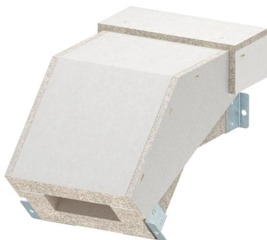
Vertikalbogen fallend für Brandschutzkanal PYROLINE® Con S, Typ BSKH09-K0511 bestehend aus wasser- und frostbeständigen Glasfaserleichtbeton zur Herstellung von vertikalen Richtungsänderungen (45°) im Kanalverlauf. Fertig montierte Verbindungsbeschläge sorgen für eine schnelle Montage vor Ort, lose aufgelegte Deckel für eine schnelle Revision und Nachbelegung. Inklusive Verbindungsschrauben und Dichtungstreifen.
