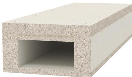
Brandschutzkanal aus wasser- und frostbeständigen Glasfaserleichtbeton der Baustoffklasse A1 gemäß EN 13501-1 zur brandsicheren Verlegung von Kabeln in Flucht- und Rettungswegen und zum Funktionserhalt sicherheitsrelevanter Anlagen. Klassifizierung I120 als I-Kanal gemäß DIN 4102 Teil 11 und Klassifizierung E90 als E-Kanal gemäß DIN 4102 Teil 12.
