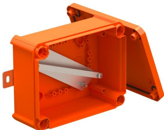
Unbestückter, geschlossener Verbindungs- oder Kabelabzweigkasten zur freien Konfektionierung mit Keramikklemmen und Kabelverschraubungen. Maß A gibt die verfügbare Tragschielenlänge für die Verdrahtungsklemmen an. Ausreichender Verdrahtungsraum durch diagonal angeordnete Tragschiene. Befestigung an gut zugänglichen Außenlaschen aus Edelstahl. Zugelassen für Kabelanlagen mit elektrischem Funktionserhalt nach DIN 4102 Teil12 mit den Klassen E30, E60 und E90.
