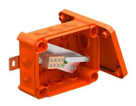
Verbindungskasten für Datentechnik mit weichen Einsteckdichtungen. Paarige Anzahl der hochtemperaturbeständigen Keramikklemmen passend zu Datenleitungen. Grün-gelb gekennzeichnete Schutzleiter-/Schirmklemme. Befestigung an gut zugänglichen Außenlaschen. Zugelassen für Kabelanlagen mit elektrischem Funktionserhalt nach DIN 4102 Teil 12 mit den Klassen E30, E60 und E90. Keramikklemmen wurden nach DIN EN 60998-2-1:2004 geprüft.
