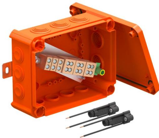
Kabelabzweigkasten mit zwei Sicherungshaltern und weichen Einsteckdichtungen. Ausreichender Verdrahtungsraum durch diagonal angeordnete Anschlusseinheit mit komplett vormontierten hochtemperaturbeständigen Keramikklammern. Grün-gelb gekennzeichnete Schutzleiterklemme. Befestigung an gut zugänglichen Außenlaschen. Zugelassen für Kabelanlagen mit elektrischem Funktionserhalt nach DIN 4102 Teil 12 mit den Klassen E30, E60 und E90. Keramikklammern wurden nach DIN EN 60998-2-1:2004 geprüft.
