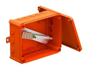
Verbindungskasten mit weichen Einsteckdichtungen. Ausreichender Verdrahtungsraum durch diagonal angeordnete Anschlusseinheit mit komplett vormontierten hochtemperaturbeständigen Keramikklemmen. Grün-gelb gekennzeichnete Schutzleiterklemme. Befestigung an gut zugänglichen Außenlaschen. Zugelassen für Kabelanlagen mit elektrischem Funktionserhalt nach DIN 4102 Teil 12 mit den Klassen E30, E60 und E90. Keramikklemmen wurden nach DIN EN 60998-2-1:2004 geprüft.
