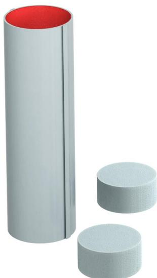
Innenbeschichtete Rohrschalen mit Klickverschluss. Innenraum vollständig mit Kabeln und Elektroinstallationsrohren belegbar. Anwendung im Innenbereich. CE-gekennzeichnetes, europäisch zugelassenes Bauprodukt gemäß ETA-13/0904 und deutscher allgemeiner Bauartgenehmigung. Feuerwiderstand bis 120 Minuten.
