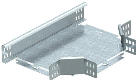
T-Abzweigstück, horizontal, für alle Kabelrinentypen mit der Seitenhöhe 60 mm. Das Formteil wird in unmontiertem Zustand geliefert. Alle Seiten sind für die gleiche Kabelrinnenbreite.
