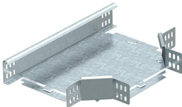
T-Abzweigstück, horizontal, für alle Kabelrinentypen mit der Seitenhöhe 60 mm. Das Formteil wird in unmontiertem Zustand geliefert. Alle Seiten sind für die gleiche Kabelrinnenbreite.
