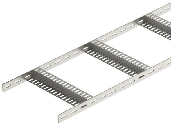
Schiffskabelleiter leichte Ausführung, mit gelochtem Seitenholm in der Seitenhöhe 35 mm mit eingeschweißten, gelochten Z-Sprossen. Belastung geprüft nach IEC in Kombination mit Verbinder Typ SLV.
