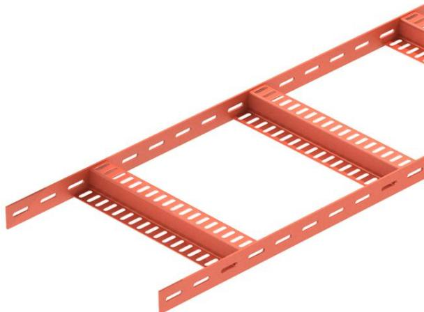
Schiffskabelleiter leichte Ausführung, mit gelochtem Seitenholm in der Seitenhöhe 35 mm mit eingeschweißten, gelochten Z-Sprossen. Belastung geprüft nach IEC in Kombination mit Verbinder Typ SLV. Schweißgrundierung Typ SIGMA-WELD 199, auch in weiß erhältlich.
