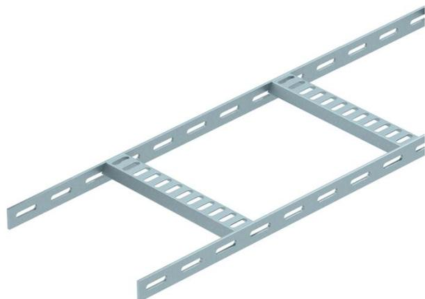
Schiffsbau-Kabelleiter mit gelochtem Seitenholm in der Seitenhöhe 25 mm, mit eingeschweißten, nach unten offenen und gelochten Trapezsprossen. Belastung geprüft nach IEC in Kombination mit Verbinder Typ SLV. Die Schiffsbau-Kabelleiter inklusive Formteile ist auf Anfrage auch in Edelstahl lieferbar. Pulverbeschichtung nach RAL-Farben möglich.
