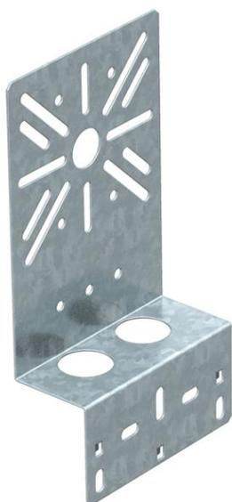
Abgewinkelte Montageplatte zur Befestigung am Seitenholm der Kabelrinne. Durch die Mittenlochung der Montageplatte lässt sich der Abzweigkasten Typ B9/T sehr einfach mit der beiliegenden Verschlusschraube befestigen. Ausgeprägte Laschen bieten eine Schnellbefestigung. Befestigungsschraube FRS B 6x12 bitte separat bestellen.
