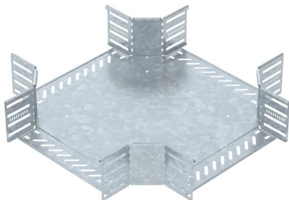
Kreuzung zum Erstellen einer horizontalen Abzweigung, Formteil für rast- und schraubbare Kabelrinnen Seitenhöhe 110 mm. Schraubenlose Montage mit Doppelklemmen oder Schraubverbindung mit Flachrundschräuben FRS und Kombimuttern M6. Einsetzbar im Innen- und Außenbereich. Befestigungsmaterial muss separat bestellt werden.
