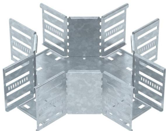
Kreuzung zum Erstellen einer horizontalen Abzweigung, Formteil für rast- und schraubbare Kabelrinnen Seitenhöhe 110 mm. Schraubenlose Montage mit Doppelklemmen oder Schraubverbindung mit Flachrundschauben FRS und Kombimuttern M6. Einsetzbar im Innen- und Außenbereich. Befestigungsmaterial muss separat bestellt werden.
