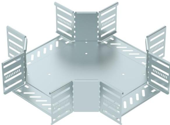
Kreuzung zum Erstellen einer horizontalen Abzweigung, Formteil für rast- und schraubbare Kabelrinnen Seitenhöhe 110 mm. Schraubenlose Montage mit Doppelklemmen oder Schraubverbindung mit Flachrundschrauben FRS und Kombimuttern M6. Einsetzbar im Innenbereich. Befestigungsmaterial muss separat bestellt werden.
