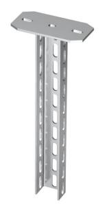
Hängestiel (U-Profil) mit angeschweißter Kopfplatte. Zur Befestigung an waagerechten Betondecken und Stahlträgern. Ab der Auslegerbreite 400mm oder der Montage des Auslegers am Ende des Hängestiels empfiehlt sich der Einsatz des Distanzstücks Typ DSK 61.
