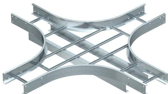
Kreuzung, horizontal, für alle Weitspannkabelleitern mit der Seitenhöhe 110 mm. Zur weiteren Stabilisierung sollten im Bereich der Formteile Unterstützungen vorgesehen werden.
