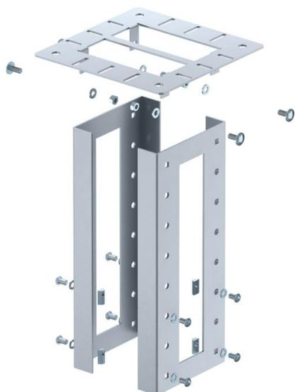
Deckenbefestigung zur Befestigung der ISS-Industriesäule an der Decke. Im Lieferumfang enthalten sind 2 U-förmige Profile aus 3 mm Stahlblech, die Befestigungsplatte für die Decke und das erforderliche Montagezubehör inkl. Nutensteine. Die Deckenbefestigung ist an dem Säulenprofil variabel höhenverstellbar.
