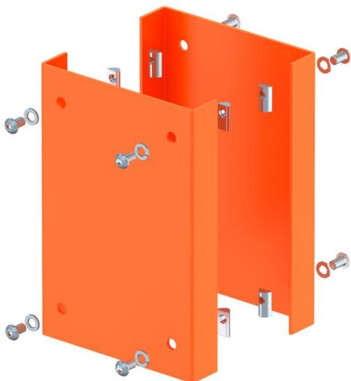
Anfahrerschutz als mechanischer Schutz der ISS-Industriesäule im Bodenbereich. Im Lieferumfang enthalten sind 2 U-förmige Schutzprofile aus 3 mm Stahlblech und 8 Befestigungsschrauben mit Nutensteinen zur Montage am Säulenprofil.
