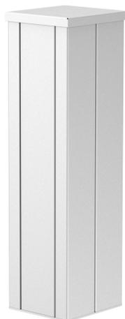
ISS Installationssäule 2-zügig aus Aluminium mit 76,5-mm-Systemöffnung. Leer, bestückbar mit handelsüblichen Geräten (Steckdose, Telefon, usw.), max. 8 Geräte.
