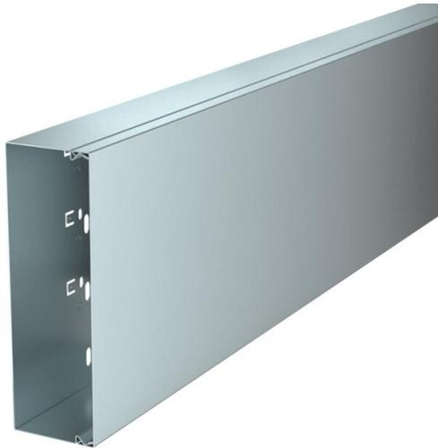
Kanaloberteil und -unterteil mit Bodenlochung. Der Potentialausgleich ist ohne weitere Hilfsmittel zwischen Unter- und Oberteil gewährleistet. Auf dem Boden ist eine Schlaufenlochung, die zur Aufnahme der Trennwand dient.
