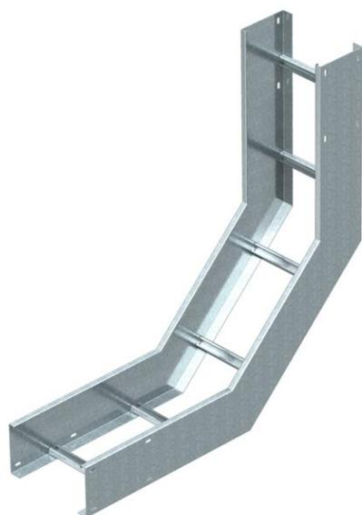
Bogen 90°, vertikal, für alle Weitspannkabelleitern mit der Seitenhöhe 160 mm. Zur weiteren Stabilisierung sollten im Bereich der Formteile Unterstützungen vorgesehen werden.
