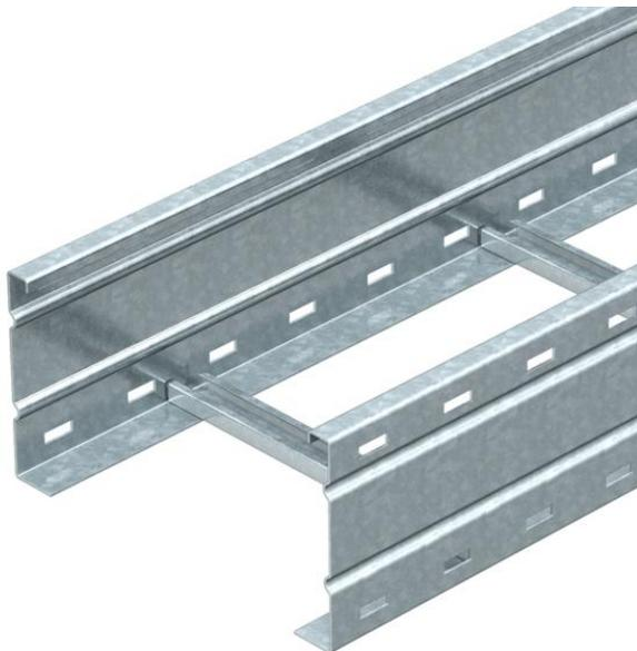
Weitspannkabelleiter mit gelochtem Seitenholm in 160 mm Seitenhöhe. Befestigung von Kabeln und Leitungen mit Bügelschelle Typ 2056. Längsverbinder Typ WRV 160 sind anteilig separat zu bestellen. Magnetische Schirmdämpfung ohne Deckel 10 dB, mit Deckel 15 dB.
