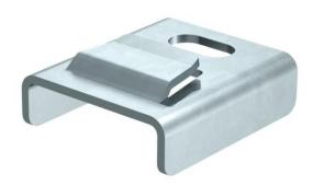
Das Anschlussbauteil ist die Verbindung der Gewindestangensicherung mit dem Abhängesystem für die Verlegearten mit Kabelleitern zum Funktionserhalt nach DIN 4102 Teil 12. Es wird in einem Abstand von maximal 100 mm vom Ausleger auf den Untergurt des Leiterholms gesteckt. Nach Montage der Gewindestange ist das Anschlussbauteil gegen Abrutschen gesichert.
