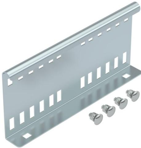
Längsverbinder als Außenverbinder zur Verbindung von Kabelleitern und Formteilen mit 110 mm Seitenhöhe und durchgängiger Holmlochung. Die Durchgängigkeit des Potentialausgleichs ist durch die Verschraubung sichergestellt.
