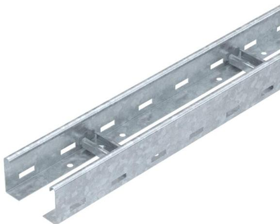
Kabelleiter in Seitenhöhe 60 mm mit eingeschweißten, nach oben offenen C30 Profilsprossen. Eingerollter Seitenholm zur Verstärkung und als Kantenschutz. Die Befestigung auf dem Ausleger erfolgt mit Klemmstücken Typ LKS 40. Das Schlitzmaß der Sprosse beträgt 16,5 mm, die passende Bügelschelle ist der Typ 2056.
