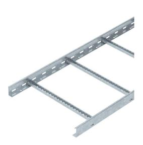
Kabelleiter in Seitenhöhe 60 mm mit eingeschweißten, nach oben offenen C30 Profilsprossen. Eingerollter Seitenholm zur Verstärkung und als Kantenschutz. Die Befestigung auf dem Ausleger erfolgt mit Klemmstücken Typ LKS 40. Das Schlitzmaß der Sprosse beträgt 16,5 mm, die passende Bügelschelle ist der Typ 2056
